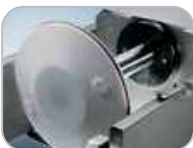
Protezione cilindro e valvole sfogo aria tampone Cylinder protection and pad exhaust valves
