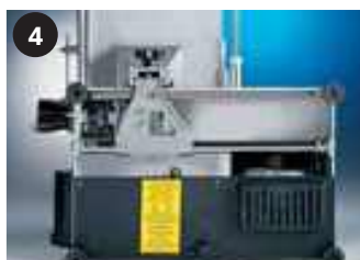
1. Paramano piatto in plexiglass 2. Elsa su manopola pressamerce Microinterruttore su paralama 3. Protezione inferiore 1. Plexiglass hand guard 2. Hilt on product pusher handle 3. Microswitch on blade cover 4. Bottom shield
